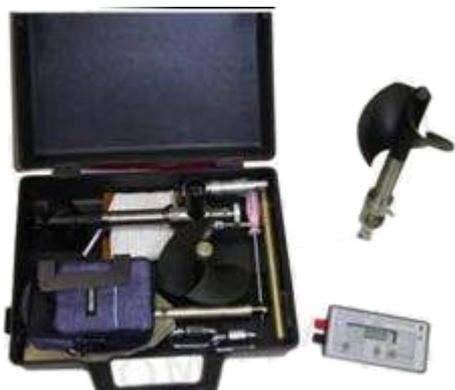
Измеритель скорости потока «ИСП-ИМ» предназначен для измерения осредненной во времени скорости водного потока в открытых руслах.
