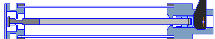
Положение 3 – Клапан открыт для слива воды, а также забора воды при отсутствии волнения
