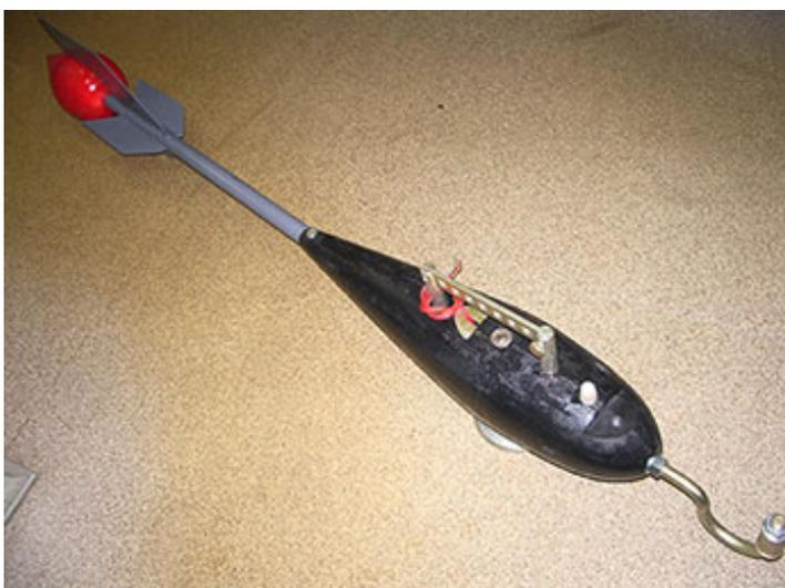
Грузы гидрометрические рыбовидные предназначены для производства гидрометрических работ на водотоках с большими скоростями. Подобные грузы, входящие в состав гидрометрической установки ГР-70, дополнительно снабжены донным контактом, поверхностным контактом и делителем напряжения.
