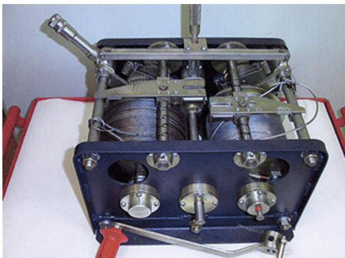
Лебедка к установке ГР-70 служит для подъема и передвижения по створу гидрометрического груза с приборами. Механизмы лебедки монтируются на раме. Подъем и опускание груза осуществляется канатом с токопроводной жилой, закрепленном на заднем барабане лебедки.
