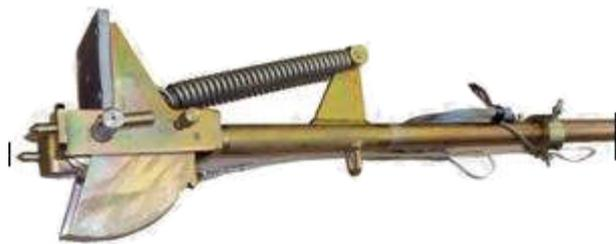
Штанговый дночерпатель «ГР-91» предназначен для взятия с нарушением структуры проб несвязанных илистых и песчано-гравелистых донных отложений со дна рек и каналов глубиной до 3 метров и скоростью течения воды до 2 м/с и озер и водохранилищ глубиной до 4 метров.
