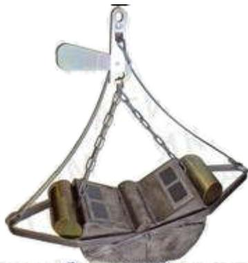
Бентосный дночерпатель предназначен для сбора поверхностного слоя грунта со дна водоема. Поверхностный слой грунта дночерпатель собирает при помощи скребков, стягиваемых тросом при подъеме дночерпателя.
